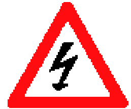
Cartello indicante la presenza di elementi sotto tensione
