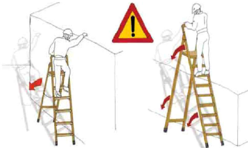
Fig. 4 - Erroneo uso della scala: posizione laterale e sistema di accesso ad altro luogo
