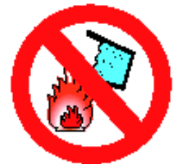
Cartello indicante il divieto di usare acqua per spegnere incendi
